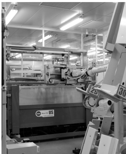
超音波洗浄ユニットにロボットアームがシリンダーを入れるところ。大三紙業のラインには超音波洗浄ユニットが2つ組み込まれている
