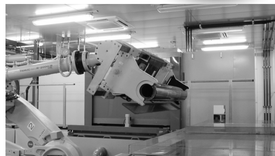
エッチング槽にシリンダーがセットされる様子
